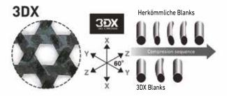
Durch den Einsatz von 3DX Kohlefasermaterial wird die Kompression des Blanks deutlich verbessert. Die Rute hat immer die gleiche Kraftübertragung – egal aus welcher Richtung der Zug kommt. Zudem schwingt die Rute deutlich weniger nach – präzisere Würfe sind die Folge. Die perfekte Hexagon 6-Eck Struktur ist in der Natur weit verbreitet und war immer schon die Basis für bedeutende technische Innovationen.
